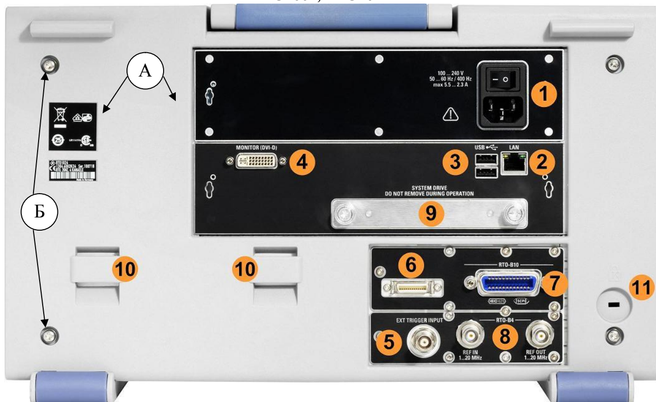
Рисунок 2. а) Места для размещения наклеек; б) Места для пломбировки от несанкционированного доступа.
